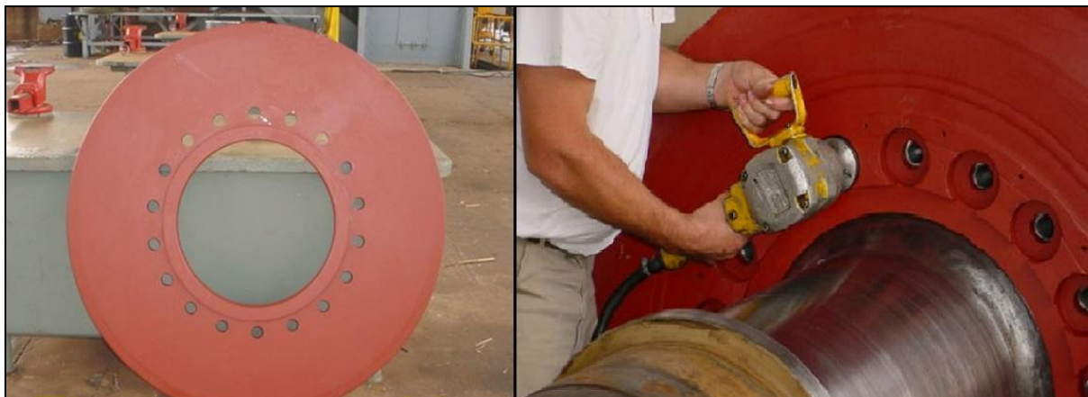
FIGURA 17 – Detalhe para montagem dos Flanges.
